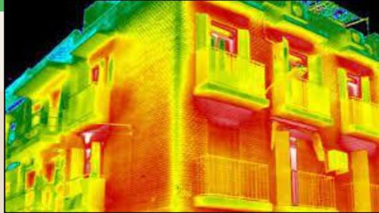
Uso de cámaras termográficas infrarrojas: Este equipo nos permite inspeccionar la edificación y ubicar de manera visual esas rendijas, por medio de tecnología infrarroja.
